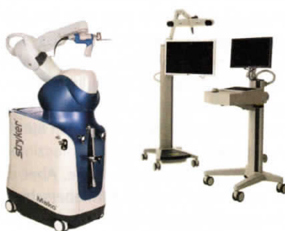
Die MAKOpasty® besteht aus drei Funktionseinheiten: Planungsstation, 3-D-Kamera zur Kontrolle der Patientenposition und Knochensäge mit Roboterarm.
